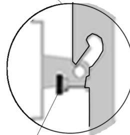
Os reguladores de inclinação que estão localizado nas haste deverão estar aberto no maximo para possibilitar a montagem. O conjunto não desmonta em posição inclinada.
